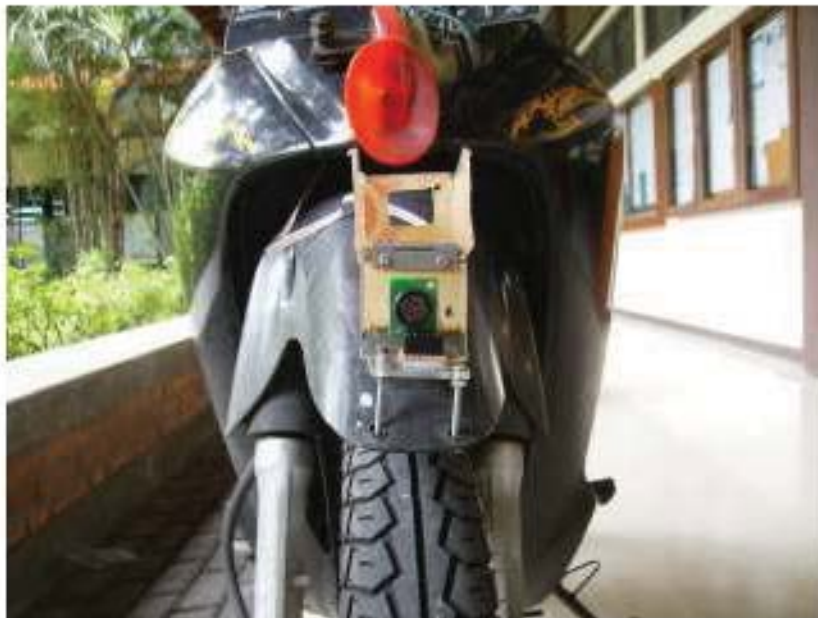
Gambar L.5 Sensor SRF02 yang terletak di penutup ban depan
